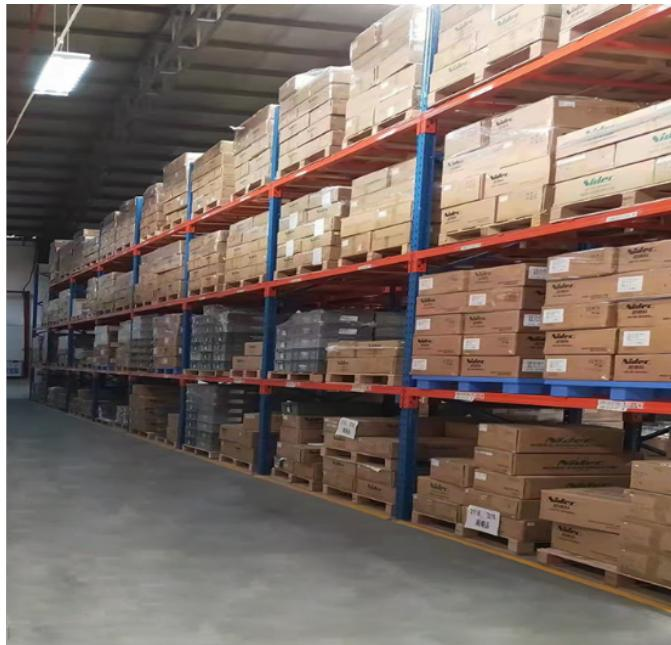
高位货架的概述：高位货架，是指高度为5米以上的货架。根据仓储设备行业的习惯定义，高度为5米以上的货架称为高位货架。它包括有：横梁托盘货架、贯通式货架、后推式货架、双深度式货架、窄通道货架、自动化立体仓库等等。是仓库使用率较普遍的一种货架，货架本身有很好的拣取效率，可实现货物的快捷存取。高位货架的立柱、横梁等主要配件均采用优良的Q235型钢制造而成，连接采用柱片与横梁插接组合的形式，一般需配合叉车共同使用。
